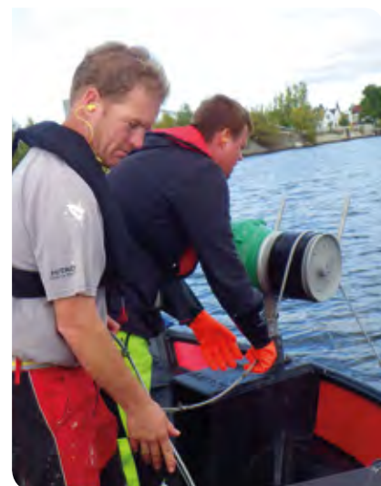
Seismikk utføres på stedet for styrt boring under Glomma
